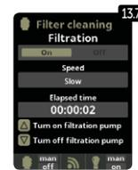
**13.7** Reinigung des Filters: Zur Reinigung des Sandfilters wird ein schneller Mehrgeschwindigkeits-Pumpenmodus verwendet.
