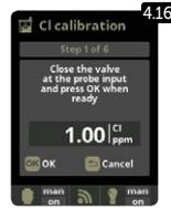
**4.14** Kalibrierung der Sonde für freies Chlor: Es wird empfohlen, dies jeden Monat während des Zeitraums, in dem der Pool genutzt wird, zu tun.
