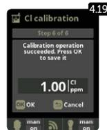
**4.17** Schritt 3 bis 6 – Cl-Kalibrierung: Öffnen Sie den Wasserdurchfluss, um 80–100 Liter/Stunde zu erreichen. Warten Sie, bis sich die Ablesung des ppm-Wertes stabilisiert hat. Warten Sie 5 bis 20 Minuten. Wenn der Wert stabil ist, drücken Sie die OK-Taste.
