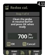
**4.9** Kalibrierung der Redox-Sonde: Es wird empfohlen, sie alle 2 Betriebsmonate durchzuführen.
