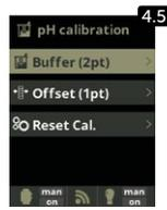
**4.5** Kalibrierung mit Lösungen (Standardlösungen pH7/pH10/neutral): Befolgen Sie die Anweisungen in sieben aufeinanderfolgenden Punkten, die auf dem Display erscheinen. (Der erste Schritt ist in Abbildung 4.6. dargestellt). Mit der Option Reset Cal werden zuvor durchgeführte Kalibrierungen gelöscht.
