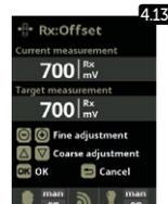
**4.12** Manuelle Kalibrierung: Ermöglicht die Einstellung der Sonde in 1 Schritt (ohne Lösungen) – nur zur Korrektur kleiner Messabweichungen empfohlen.
