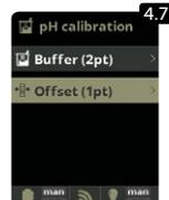
**4.7** Lassen Sie die Sonde im Wasser und verwenden Sie die Plus-/Minus-Tasten, um den gemessenen Wert an den Referenzwert (aus dem Ergebnis eines anderen Testers) anzupassen.
