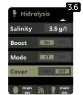
**3.6** Überdachung: Ein- oder Ausschalten der automatischen Steuerung der Chlorbildung unter der Überdachung. Mehr dazu in Kapitel 10
