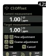
**4.20** und **4.21** Manuelle Kalibrierung: Öffnen Sie den Wasserdurchfluss und stellen Sie die Durchflussmenge auf den richtigen Wert ein (80–100/h). Warten Sie einige Minuten, bis sich die Durchflussmenge stabilisiert hat. Verwenden Sie die Plus-/Minus-Tasten, um den Chlorgehalt im Wasser einzustellen (verwenden Sie den DPD1 Tropfchentester, um den Chlorgehalt im Wasser zu bestimmen). Nachdem Sie den von DPD1 ermittelten Wert eingegeben haben, drücken Sie zur Bestätigung die OK-Taste.
