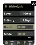
**3.4** Verstärkung: Die Salzanlage arbeitet 24 Stunden lang mit maximalen Dosen von Cl. Nach dieser Zeit kehrt die Elektrolyse auf den eingestellten Wert zurück. Die Redox-Kontrolle kann während der Verstärkung deaktiviert werden.
