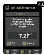
**4.6** Manuelle Kalibrierung: Ermöglicht die Einstellung der Sonde in 1 Schritt (ohne Lösungen) – nur zur Korrektur kleiner Messabweichungen empfohlen.
